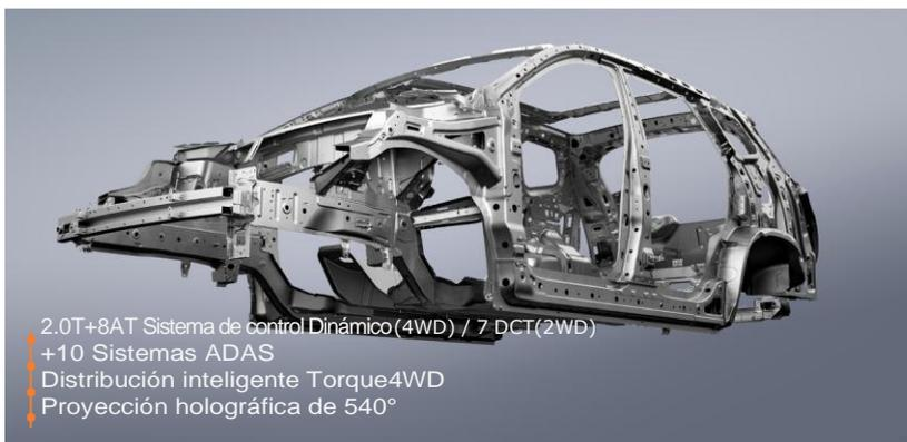
2.0T+8AT Sistema de control Dinámico (4WD) / 7 DCT(2WD)
